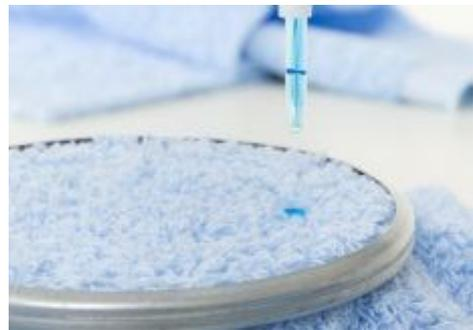
WETSOFT® NE 750의 주 구성성분은 aminofunctional silicone 및 polyglycol 기반의 block copolymer이다. 이 액상 실리콘 부분은 패브릭 외부에서 스스로 자유 이동하는 looping을 형성해 섬유간 마찰을 최소화 해주고 이로서 세정 후에도 우수한 유연성을 보장한다. 다른 한편으로 polyglycol 부분은, 일반적으로 발수성을 갖고 있는 실리콘 가공제가 투수성을 갖도록 보증해 준다.
