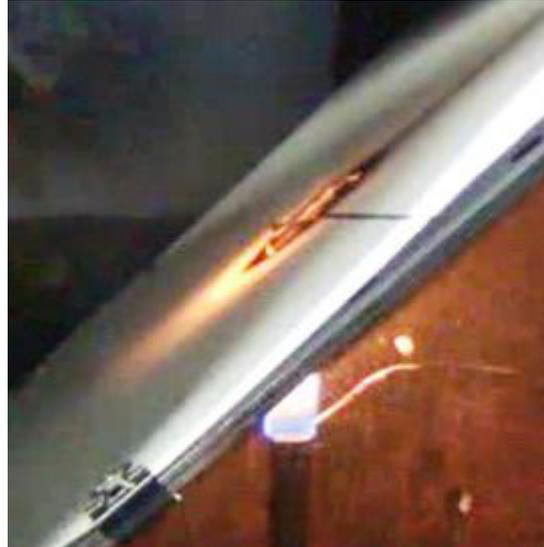
일본의 도레이(주)는 최근 polyphenylene sulfide(PPS) 섬유인 Torcon®과 자회사 Zoltek의 polyacrylonitril로 제조한 난연사를 이용하여 고성능 불꽃차단(방화) 페이퍼를 개발하였다.
