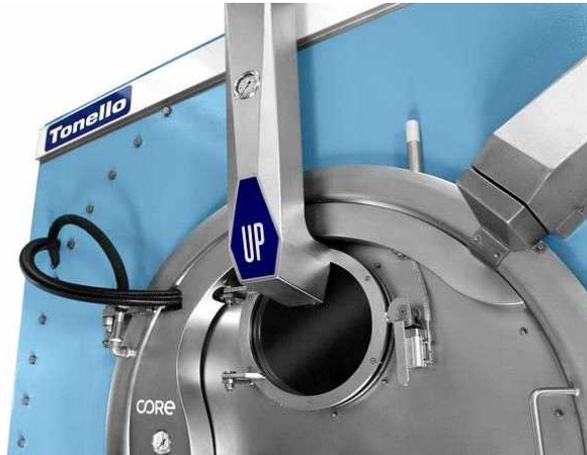
이탈리아의 Tonello는 부석사용 없이 수세기 내부에 스테인리스 재질의 마모드럼을 장착함으로써 stone wash 효과를 얻을 수 있는 새로운 가공시스템 NoStone system을 소개하였다.
