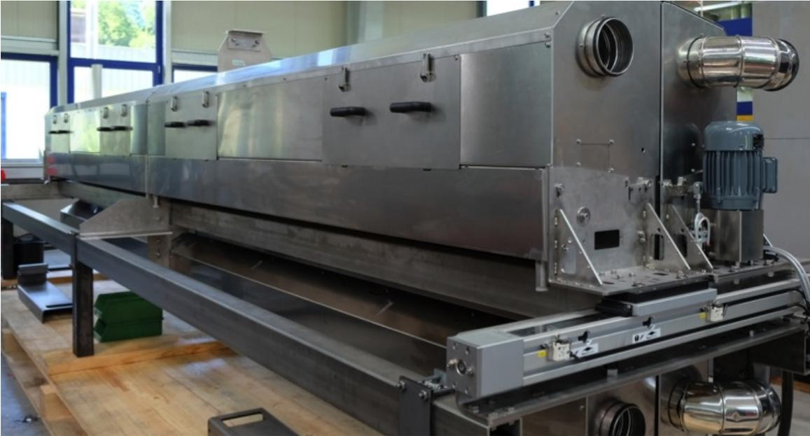
WEKO(Weitmann & Konrad GmbH & Co. KG)가 부직포 산업용으로 친수성과 발수성, 항균성, 방향성 그리고 난연성과 방오성은 물론 유연성 등의 다양한 기능을 부여할 수 있는 비접촉 방식의 정밀 one side fluid application system을 새로 구성해 본격적인 판매에 들어갔다.
